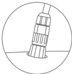
4. Подключите другой конец кабеля к PowerRay. Убедитесь, что кабель подключен надежно. Во время выполнения данных действий устройство и кабель должны быть сухими.
